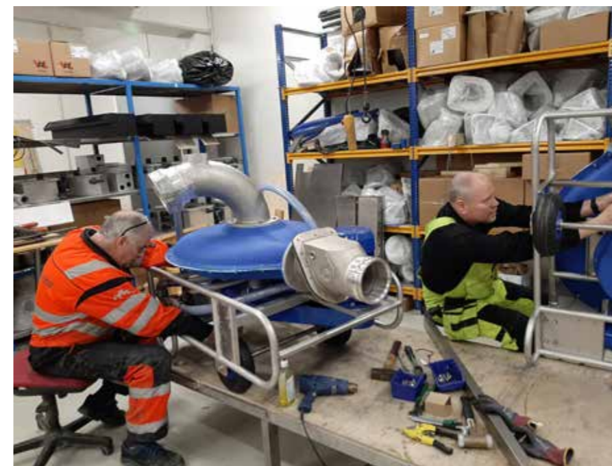
Baldur Pálsson, stálsmiður og Aðalsteinn Pálsson, „alltmuligmann“ á ryðfrúdeild Slippisins setja saman seiðadælu sem notuð er í fiskeldi.
