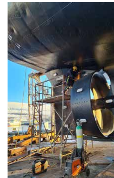
Vélvirki í Slippnum lagfærir skipsskrúfu. Það þarf að rýna vel í myndina til að koma auga á hann.
